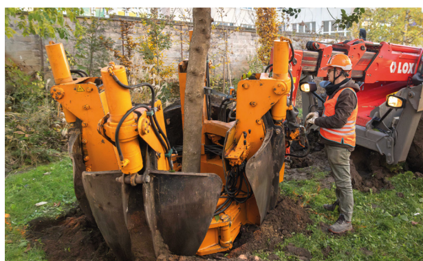
» Les 4 bèches de la transplanteuse coupent et maintiennent la motte de terre contenant les racines de l'arbre déplacé.
